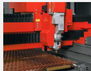
Rezalna glava z avtomatskim višinskim vodenjem
