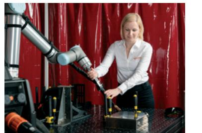
Radno područje robota može se ograničiti uporabom virtualnih sigurnosnih granica koje robot ne smije prijeći. Ovo se ograničenje odnosi samo na vrh 6 osi robota, a ostali dijelovi robotske ruke mogu prijeći tu granicu.
