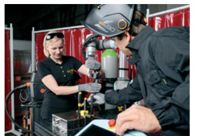
U ručnom načinu rada, robotom se može ručno upravljati u slučaju učenja. Može se pomicati tijekom pisanja programa robota uz pomoć uređaja za učenje. Pritisak na gumb na uređaju za učenje, koji omogućuje ručno upravljanje, robot je u načinu gravitacijske kompenzacije.
