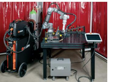
Robotski upravljač ima ugradenu funkciju za kontrolu brzine vrha 6 osi robota i pojedinačnih osi.
